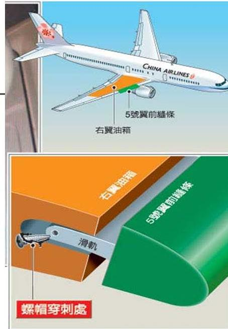
失事班機的五號翼前縫條(slat)，其中一根帶動滑軌的螺帽，已經完全離開軌道，且在飛機完成降落程序要收回slat時，螺帽向後擠壓，把油箱弄破，造成飛機瞬間大量漏油及火燒機。
