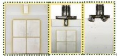
圖二.LTCC 玻璃陶瓷材料銀天線完成圖
